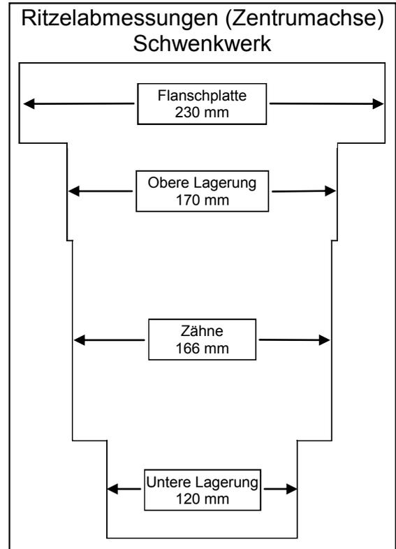
**Ritzelabmessungen und Lochkreis für Schwenkwerk 2,5 t/m
